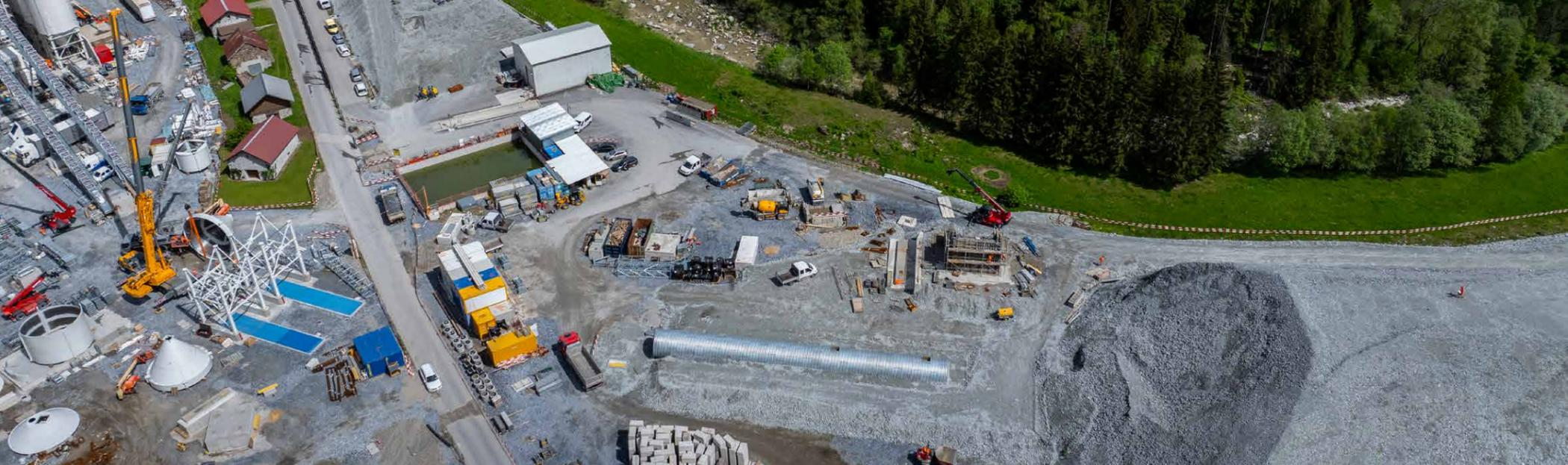
Per aumentare la sicurezza della galleria autostradale e considerando la necessità di risanare il tunnel esistente, è prevista la costruzione di una seconda canna (2TG) a est del tubo esistente, a una distanza di 70 metri.
