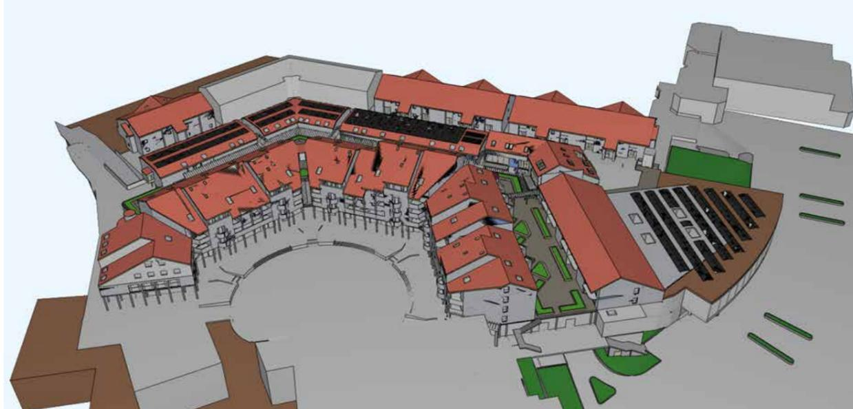
Une particularité de cette surélévation consiste à rendre conforme, sur le plan parasismique, l'ensemble du bâtiment, incluant les parties existantes et la surélévation, comme s'il s'agissait d'un nouvel édifice. Autrement dit, les structures doivent être capables de reprendre les efforts horizontaux de dimensionnement.
